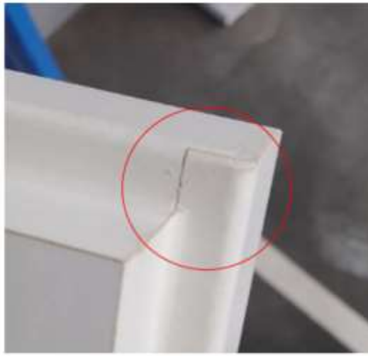
Фото 1. Образец формирования «конверта» под 90° в месте стыка кромок
